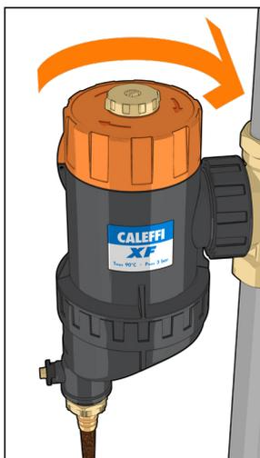
4. Após a limpeza, alinhar o indicador do manípulo superior com a referência presente no corpo do dispositivo. Voltar a fechar a torneira de descarga e proceder ao arranque da instalação.
